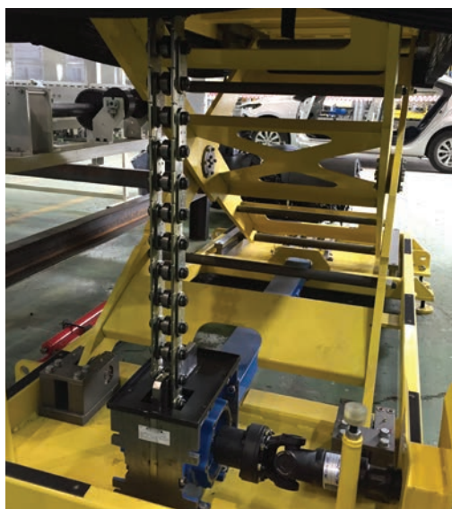
Mesa elevatória para indústria automotiva: Corrente de elevação HD Lift 60S.
