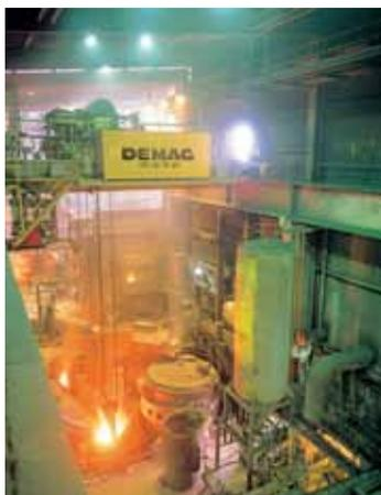
Altíssima confiabilidade e disponibilidade do equipamento de elevação são fatores chave para alguns processos de produção. Tais aplicações exigem equipamentos de elevação especialmente orientados para o trabalho a ser executado. Este é o universo de aplicação das pontes rolantes de processo, equipamentos dedicados e desenvolvidos sob a perspectiva da necessidade específica de cada processo produtivo. Alguns exemplos:
