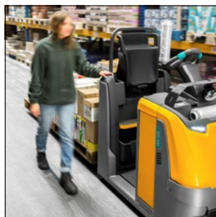
Aumento de desempenho através de operação por teclado no encosto (opcional)
