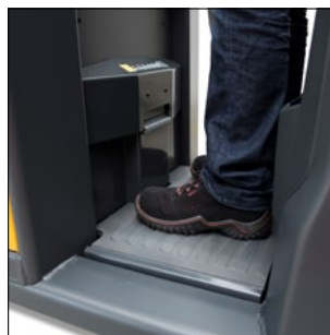
Plataforma do condutor amortecida e individualmente ajustável (opcional)
