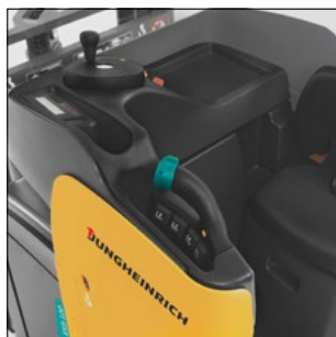
Posto do condutor ergonômico na ESD 120
