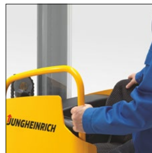
Barra de apoio para um embarque seguro, fornecida como possibilidade de montagem de diferentes opções
