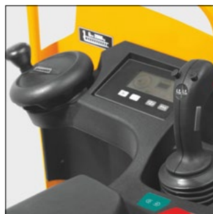
Controle de todas as funções de deslocamento e elevação com a alavanca multifuncional na ESE 220/320
