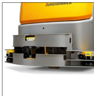
Scanner de proteção pessoal adicional para velocidades de condução mais elevadas (opcional)
